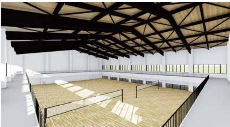
体育館アリーナ上部は開口部のメンテナンススペースを兼ねたランニングコースを設けます。体育館の面積を有効活用するため、舞台は手動式の壁面収納型ステージを設置します。
