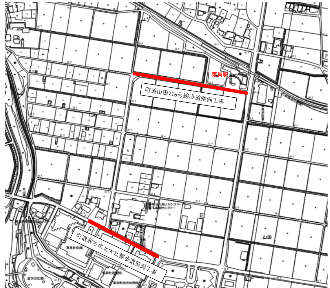
町道山田716号線歩道整備工事 施工延長 L=250m 町道瀬古泉北大社線歩道整備工事 施工延長 L=170m
