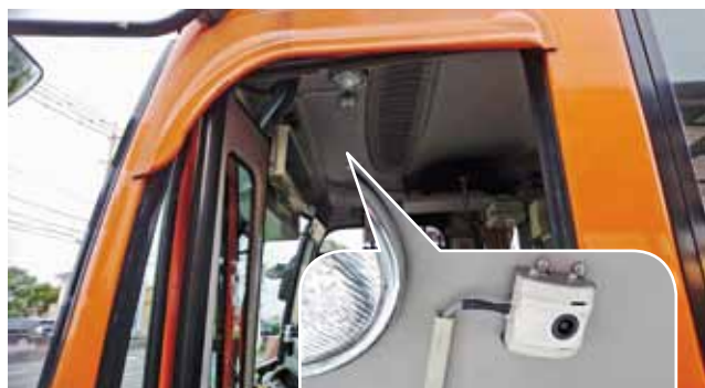
天井にセンサー
