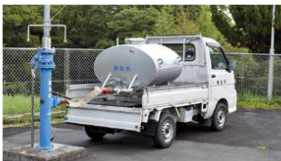
応急用給水タンク
